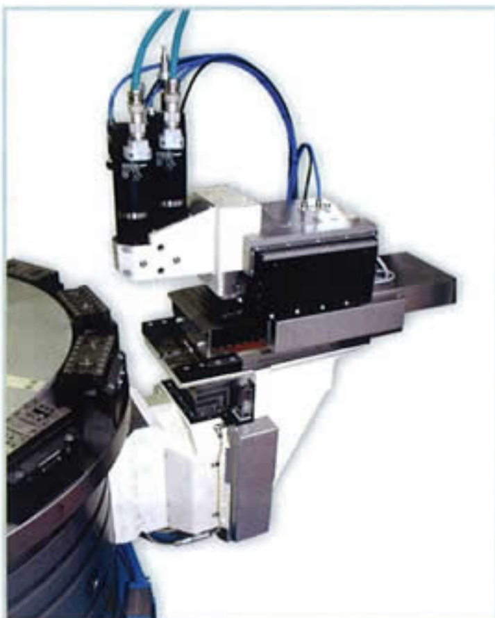
4 Bearbeitungseinheiten mit Linearmotoren haben deutliche Vorteile, sobald mehrere schnelle Operationen auf einer Bearbeitungsstation auszuführen sind
